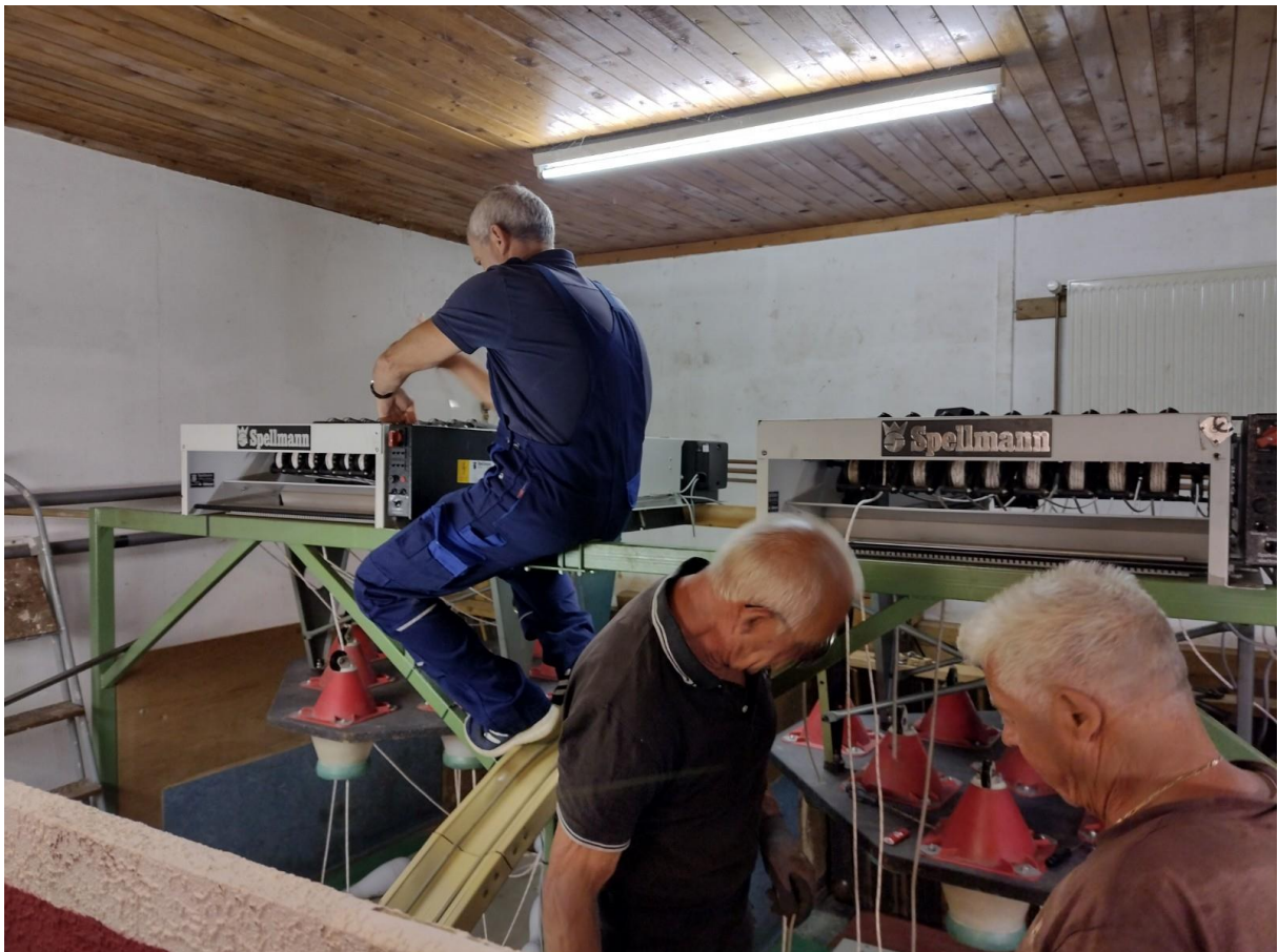
Nicht ganz bequem. Rene Allenstein bei der Montage des Seilzugkastens. Rechts daneben überprüfen Manfred Strebe und Rainer Erdmann die Seillängen.
